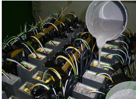
**Thermal TP0200** 导热灌封胶是一种双组份加成型有机硅体系，具有导热率高，流动性好，优越的电气绝缘性能和阻燃性能。该产品适用于高功率电源及模块，电流/功率转换单元，高功率车载充电器及充电桩等高功率器件，可满足电气/电子封装领域对高导热性的要求，同时又能保持有机硅的理想特性。。
