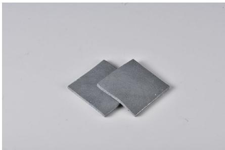
**Thermal CFP2000-US** 碳纤维高导热垫片采用碳纤维定向排列技术进行制备，其具有超高的导热系数 20.0W/m.K，同时具备良好的力学性能。该产品具有较强的弥合公差能力，可有效提升芯片散热效率。
